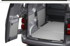
Podłoga drewniana 12mm - pojedyncze drzwi boczne L2 Zabudowy przestrzeni ładunkowej
